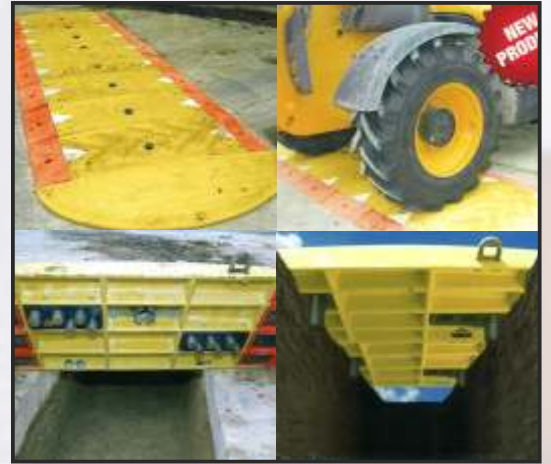
Cubre zanjas Fácil instalación en solo minutos Probado con un peso de hasta 44 Tn Cada sección sólo pesa 40 kg reduce la necesidad de equipo pesado Fácil manejo por dos operarios Nueva reducción de ruido en los bordes flexibles Anti-deslizamiento Cumple con las practicas de trabajo seguro Las secciones finales deben de ser atornilladas Longitud 1500mm Ancho 500mm Peso 40kg Fig. 01.01.0052
