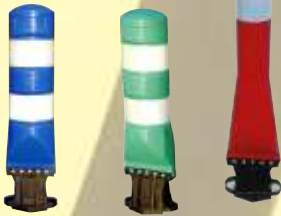
Hito leitboy Hito de vértice abatible extraflexible con base de una sola pieza Fabricado con P.E. no contaminante de alta resistencia al impacto Resistente a la degradación por los rayos solares Dotado de un sistema de anclaje en material polimérico que le proporciona una extraordinaria flexibilidad Fig. 01.01.0042
